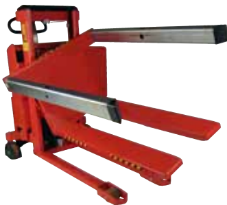
Rotator mit einstellbaren Boxhaltern lässt sich einfach für Boxbreiten von 800 mm zu 1200 mm anpassen.
